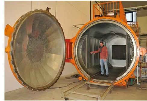
Jochen Lanio im Autoclav, hier werden die Scheiben unter Druck und mit hohen Temperaturen gebacken, also laminiert.
