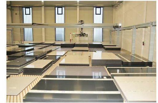
Vor dem Zusammenlegen und Laminieren der Scheiben werden sie von einem Roboter gesammelt und zur Zuschnittanlage gebracht.
