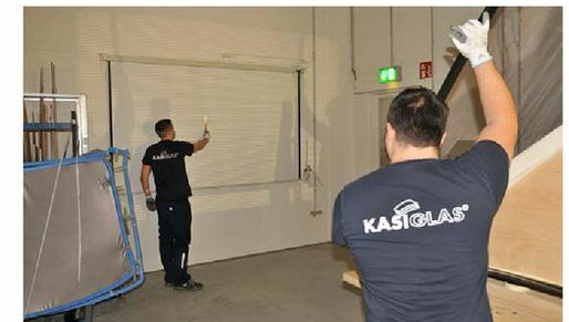
Prüfen, ob die Scheibe die Durchsicht verzerrt. Mit einem Projektor werden Streifen durchgeworfen und auf der Leinwand gemessen.
