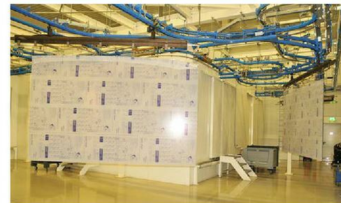
Piccobello sauber! Die Scheiben gehen per Rollbahnen zum entfolieren und säubern; danach erfolgt das Beschichten oder Laminieren.
