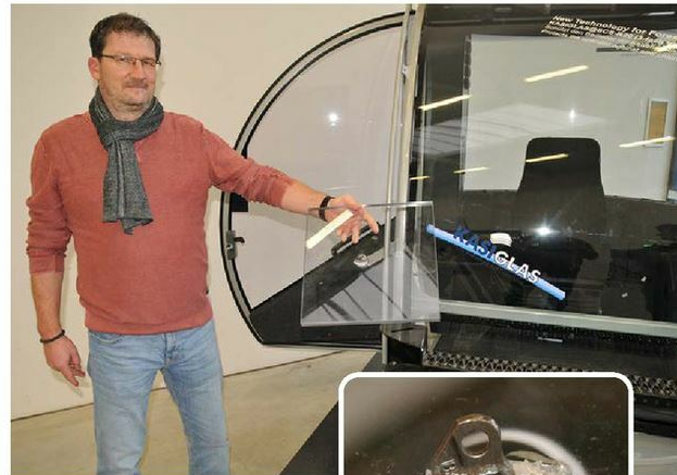
Oben: Jochen Lanio zeigt ein Kettenglied, das von der Sicherheitsscheibe aufgehalten wurde (rechts).
